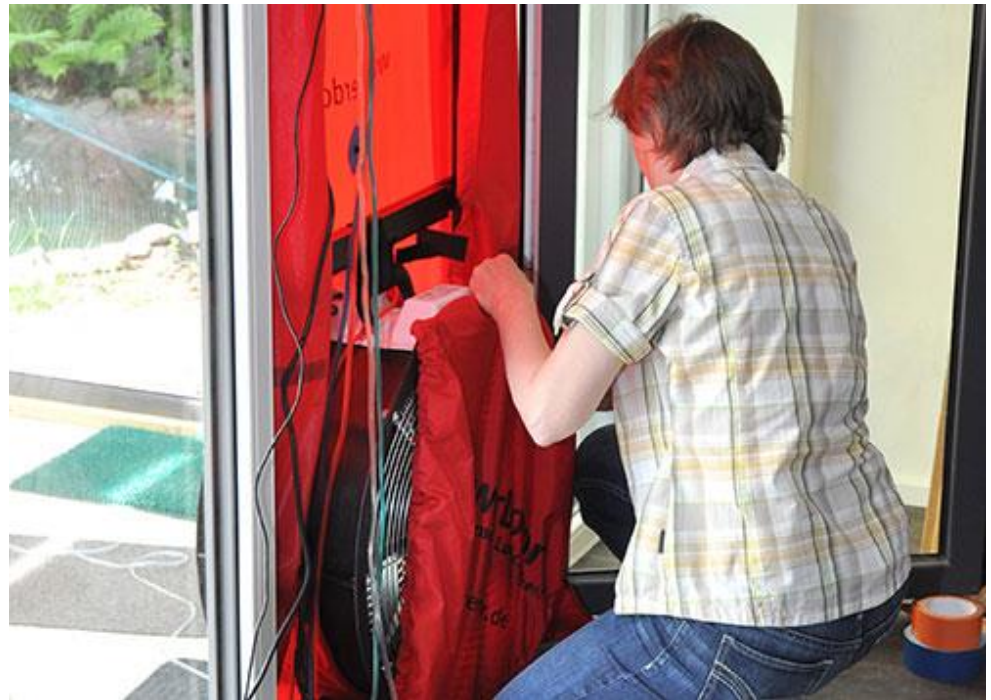
Abb. 2: Die Luftdurchlässigkeitsmessung ist ein effektives Instrument der Qualitätssicherung im Neubau wie bei Modernisierungsmaßnahmen. © Foto: FLiB
